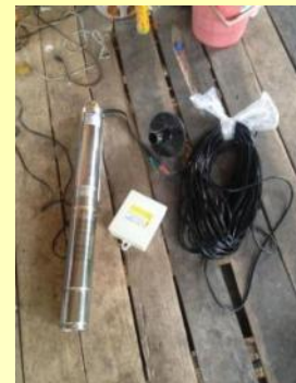
4. ปั้มน้ำขับเคลื่อน
